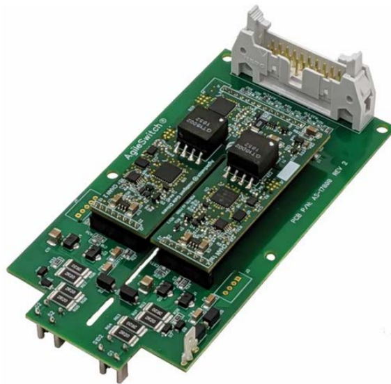
Bild 9. Dual-SiC-Gate-Treiber-Board von Microchip (Bild: RS Components)
